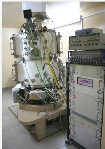
Стенд нанолитографии (слева), тестовая маска и первое изображение линий, полученное на нанолитографе
